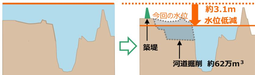
※H18以前の河道断面を用いて今回出水量時の水位を推算
