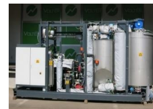
木質バイオマス利用 熱電併給装置
