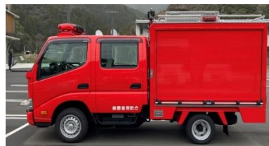
小型動力ポンプ積載車(3.5t未満)
