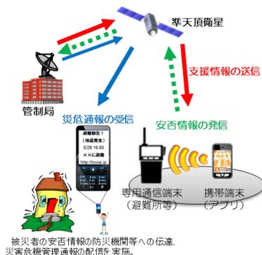
準天頂衛星システムによる災害危機管理情報の提供を行い、発災後早期の災害情報の通知等を実現。
