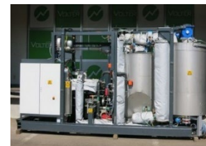
木質バイオマス利用 熱電併給装置
