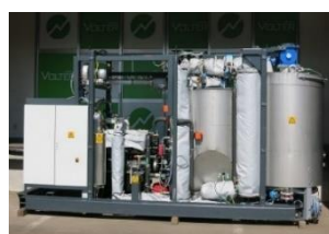
木質バイオマス利用熱電併給装置
