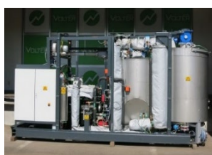
木質バイオマス利用 熱電併給装置
