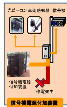
停電の際、予備電源を常設し、信号機等に電力供給
