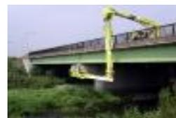
橋梁点検車を使った橋梁点検
