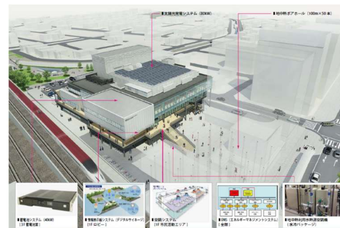
導入した次世代エネルギーシステム
