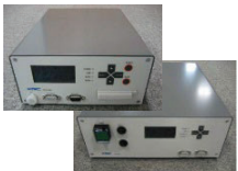
新型高感度地震観測装置 (上: AD装置、下: 電源装置)
