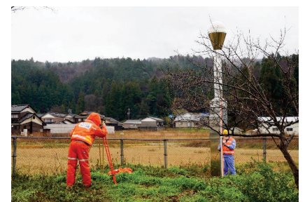
電子基準点「輪島」の現地確認
