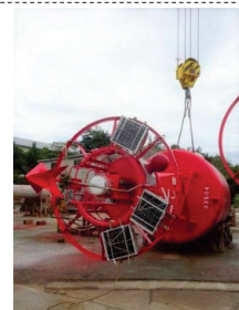
①袖ヶ浦浮標基地 （コスト縮減の取組事例） 定期交換にあわせて 陸上に監視装置を設置
