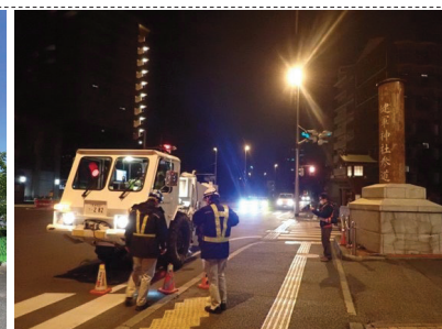
左：立田山断層を対象に熊本城公園付近で実施したボーリング調査風景 右：水前寺断層を対象とした反射法地震探査風景
