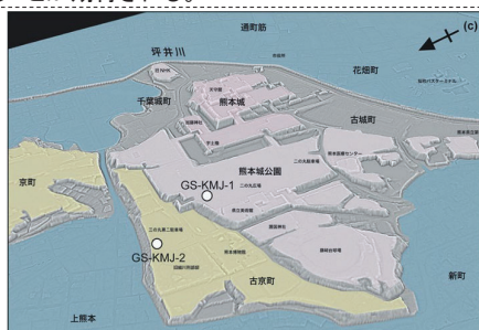
熊本城公園とその周辺の鳥瞰図。立田山断層を対象として公園内で実施した2ヶ所のボーリング調査地点を白丸で示す。鳥瞰図は国土院が管理する航空レーザ測量データから作成。
