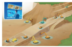
1 人のオペレータが遠隔で複数の建機を稼働
