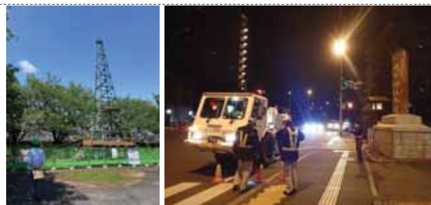
左：立田山断層を対象に熊本城公園付近で実施したボーリング調査風景 右：水前寺断層を対象とした反射法地震探査風景
