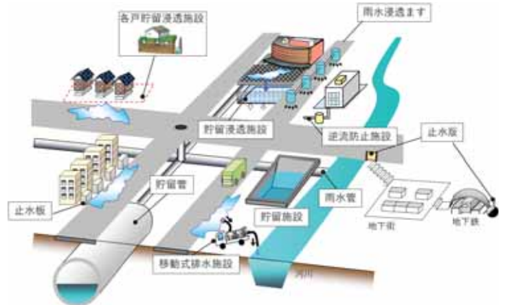
下水道による浸水対策のイメージ
