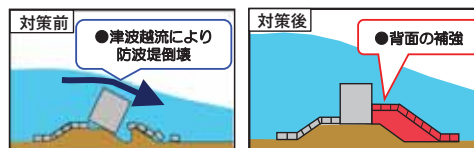
防波堤の粘り強い構造への補強（イメージ）
