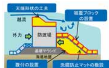
「粘り強い構造」を導入した防波堤
