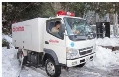
【電源確保のための移動電源車の出動】
