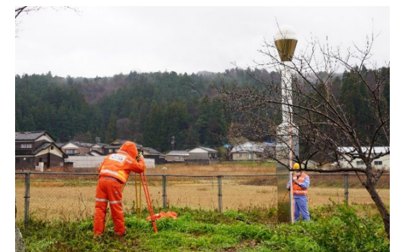
発災後に実施した電子基準点「輪島」の現地確認
