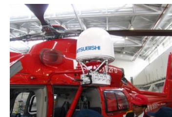
ヘリサットアンテナ
