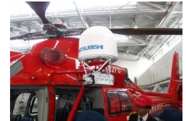
ヘリサットアンテナ
