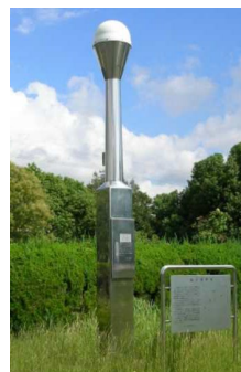
山口県周南市の電子基準点でバッテリー交換を実施
