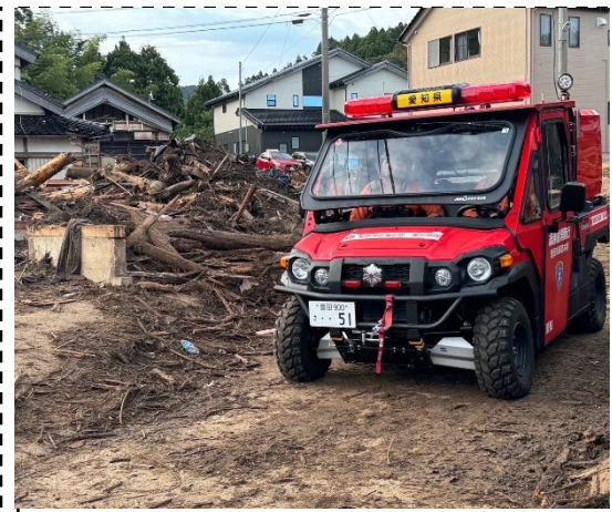
小型救助車が悪路や狭い地域において救助資機材を輸送するなどの活動を行った
