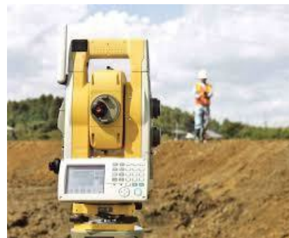
【トータルステーションの測量】
