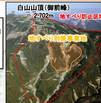
メンテナンスにより排水機能を回復させることにより、地すべりを誘発する地下水位を低下させることに成功
