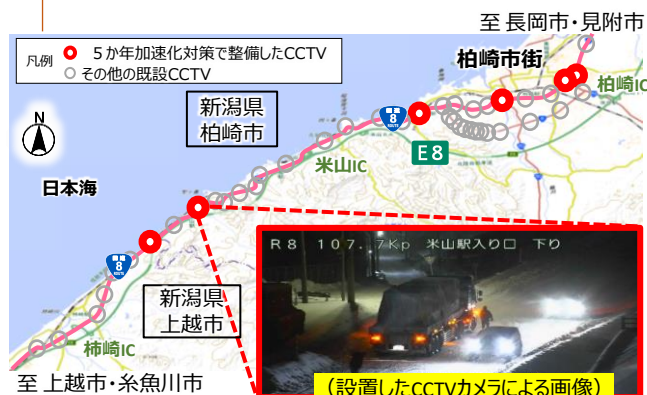
令和4年12月にCCTVカメラを設置 →立ち往生車両の早期発見が可能に
