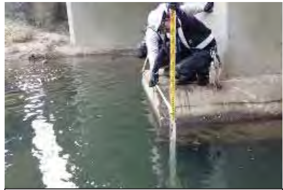
最大1.1mの洗掘を確認
