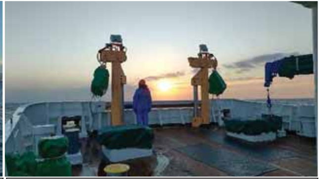
多くの災害救援物資を搭載できる広い甲板と揚降設備。陸上に100V電源を90日間供給可能
