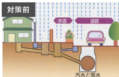
下水の排除方式(合流式)
