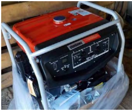
非常用発電機
