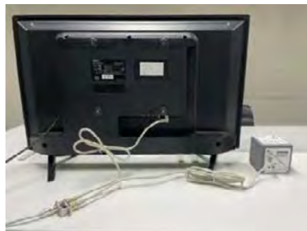
<地上デジタル放送波を活用した災害情報伝達手段(IPDC)の戸別受信機設置イメージ>
