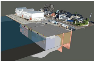
3次元データの活用例 (出来上がり全体イメージの確認)
