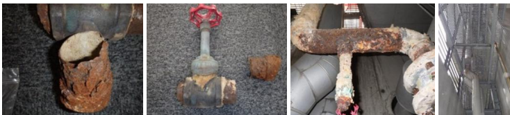
腐食の状態に合わせ、部品の交換や延命処置を実施することで、安定的な研究環境を確保
