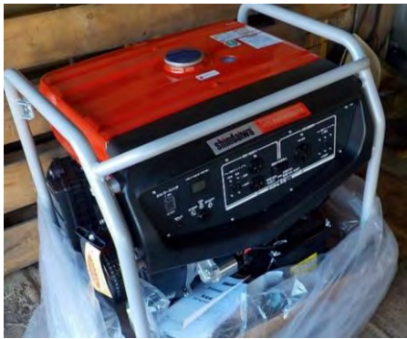
非常用発電機
