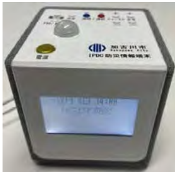
<地上デジタル放送波を活用した災害情報伝達手段(IPDC)の戸別受信機設置イメージ>
