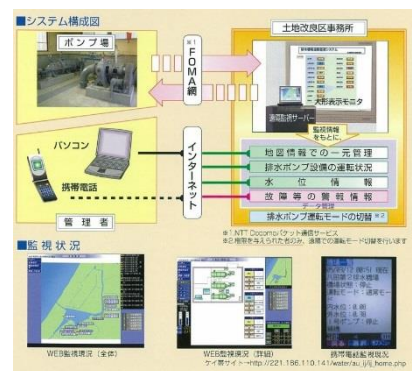
▲排水機場遠隔監視システム
