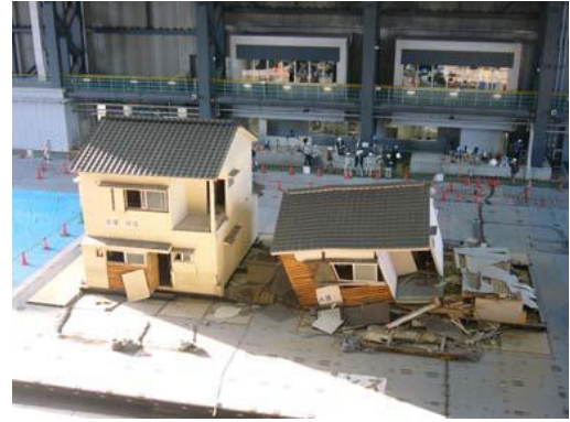
▲住宅の耐震補強試験の様子 (屋根に同社製品を使用)
