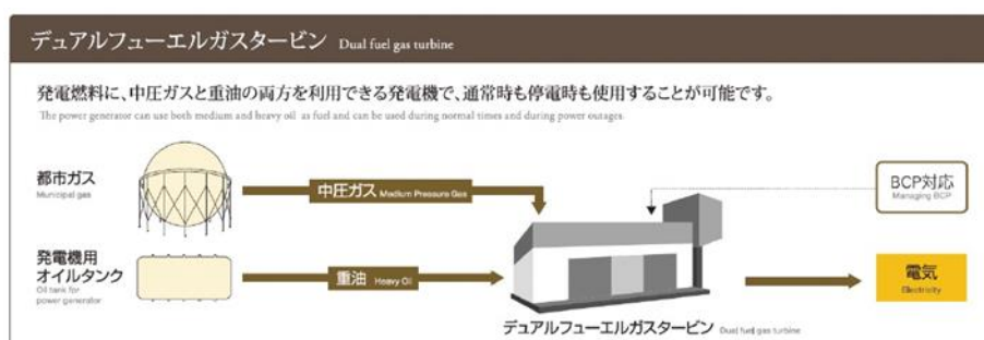
▲非常用発電用ガスタービン
