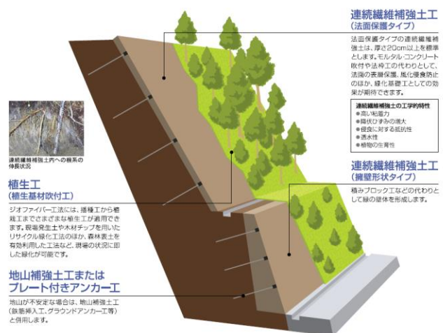
▲ジオファイバー工法の模式図
