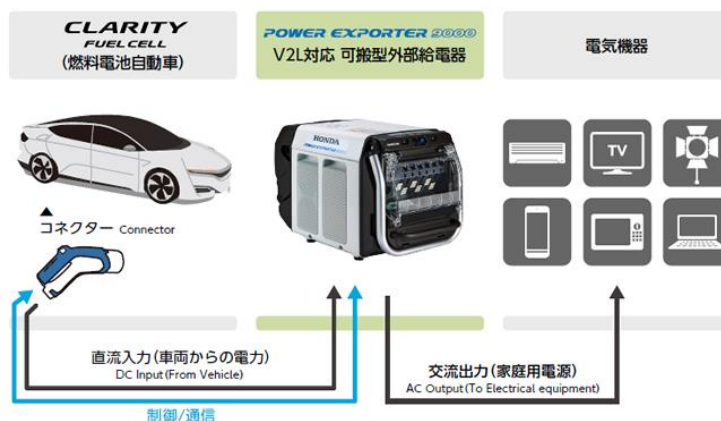
▲外部給電器のシステム構成
