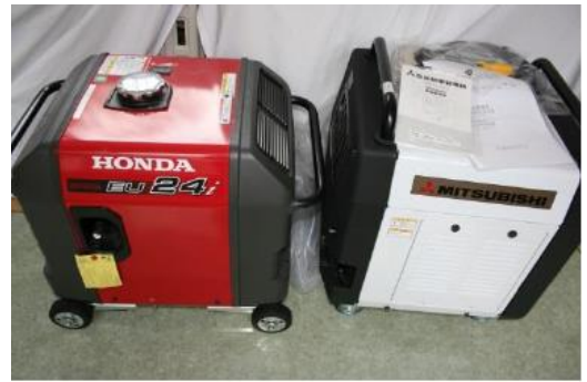
▲自家発電機（左:ガソリン 右:ガス）
