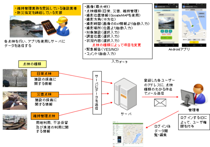
▲漁港施設点検システムの概要
