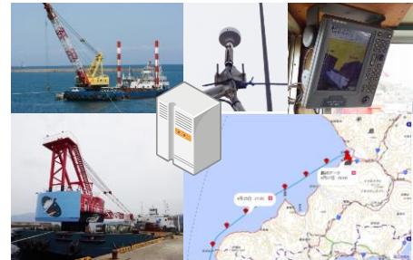
▲航路表示システムと作業船
