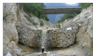
▲スイスでの土石流の捕捉実験
