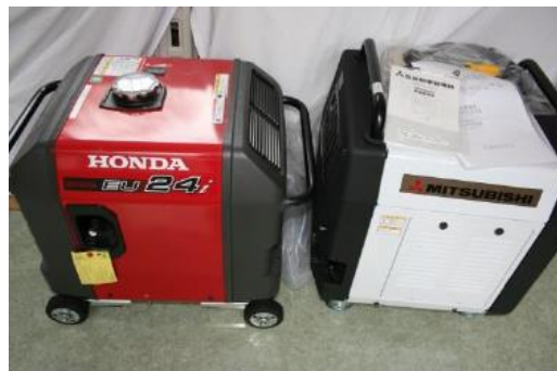
▲自家発電機（左:ガソリン 右:ガス）
