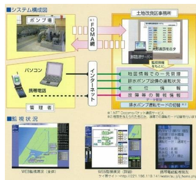
▲排水機場遠隔監視システム
