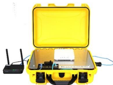
▲可搬型 Wi-Fi ステーション 屋内タイプ
