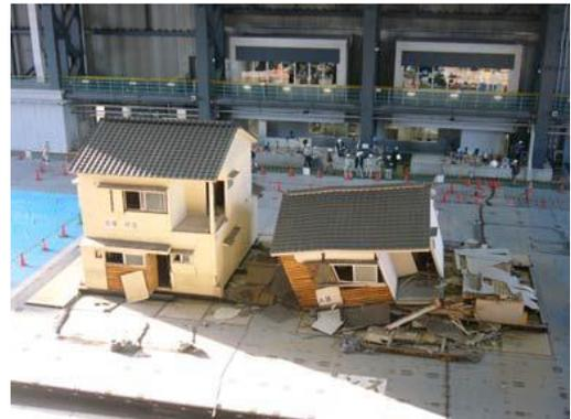
▲住宅の耐震補強試験の様子
