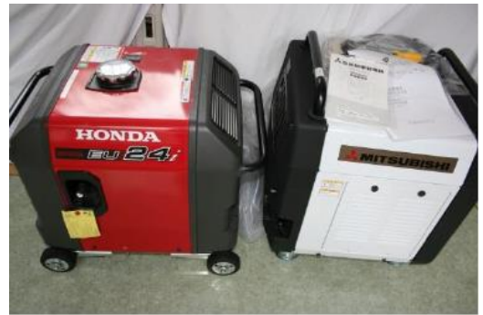
▲自家発電機（左:ガソリン 右:ガス）
