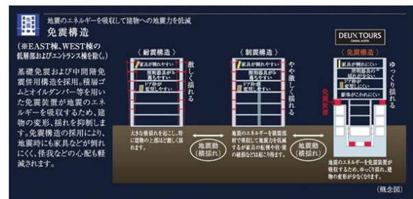
▲同マンションの免震構造
