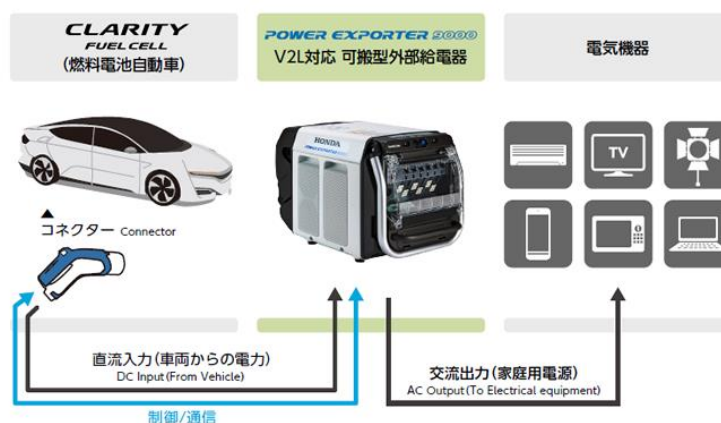
▲外部給電器のシステム構成
