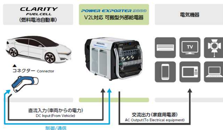
▲外部給電器のシステム構成
