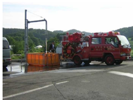
▲ 給水栓からの給水の様子
