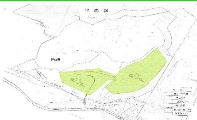
▲採石場のうち緑部分が雪堆積場
