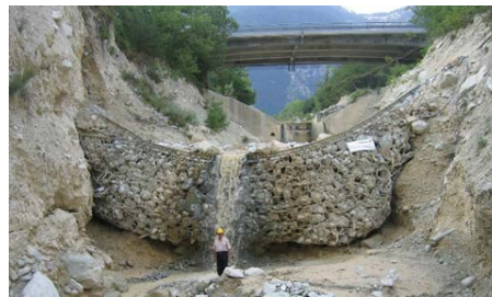
▲スイスでの土石流の捕捉実験
