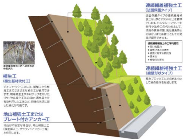
▲ジオファイバー工法の模式図
