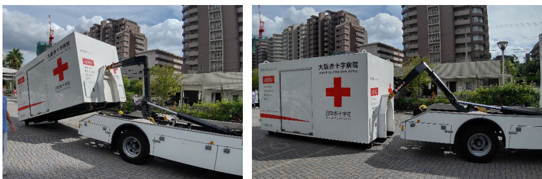
図4-2 コンテナ型dERU(自動昇降機により下ろされている状況)
